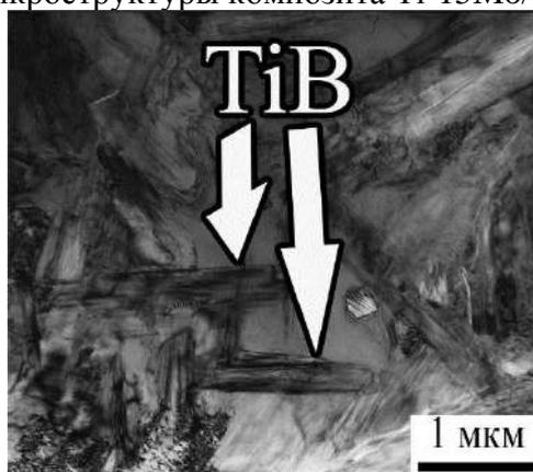
Рис. 2. ПЭМ изображение микроструктуры композита Ti-15Mo/TiB
