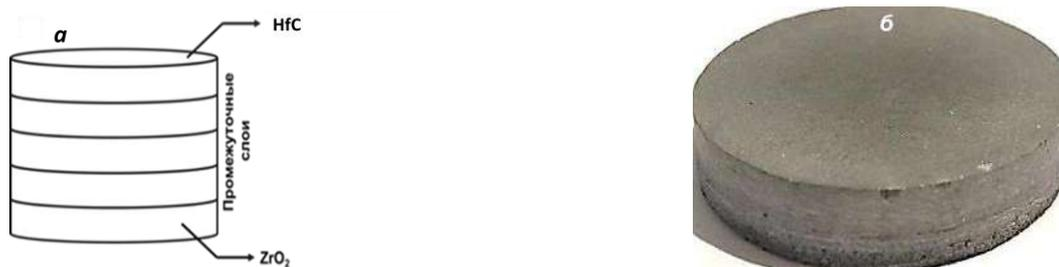
Рис. 1 а) структурная схема теплозащитного керамического композита HfC-ZrB<sub>2</sub>-SiC-ZrO<sub>2</sub>; б) макроснимок образца теплозащитного керамического композита HfC-ZrB<sub>2</sub>-SiC-ZrO<sub>2</sub>.
