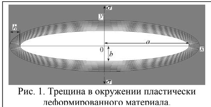
Рис. 1. Трещина в окружении пластически деформированного материала.
