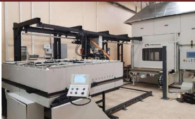
Рис. 1. Опытная автоматизированная линия термоштамповки ТКМ
